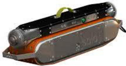
Kuva 3.20. Itsenäisesti liikkuva kuvausrobotti. https://www.redzone.com/
