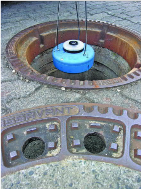
Kuva 4.2. Kaivojen tutkimiseen soveltuva laitteisto. https://www.mswmag.com/g/weftec-product-preview/2015/08/rapidview_ibak_north_america_panoramo_si
