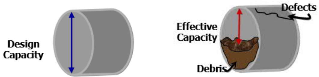
Kuva 1.2. Verkon suunniteltu kapasiteetti (design capacity) vs. toiminnallinen kapasiteetti (effective capacity). Havainnekuva. (Rowe et al. 2004)
