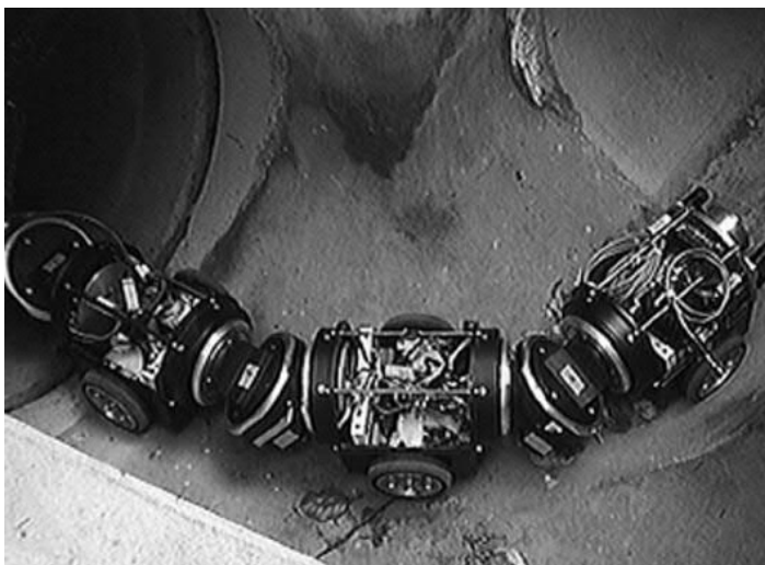
Kuva 3.21. Itsenäisesti liikkuva kuvausrobotti. https://www.researchgate.net/figure/MAKRO-robot-while-turning-in-a-T-joint-of-sewer-test-net_fig6_222443987
