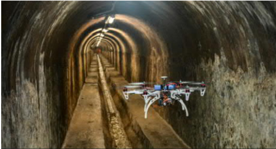
Kuva 4.4. Dronetutkimusta viemäritunneleissa. https://www.thelocal.es/20151207/could-drones-soon-replace-workers-in-barcelonas-sewers
