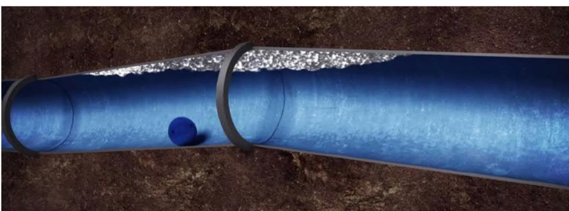
Kuva 3.24. SmartBall®-tutkimuslaitteen havainnekuva. https://puretechltd.com/articles/lyon-inspects-water-main-for-leaks-with-smartball/
