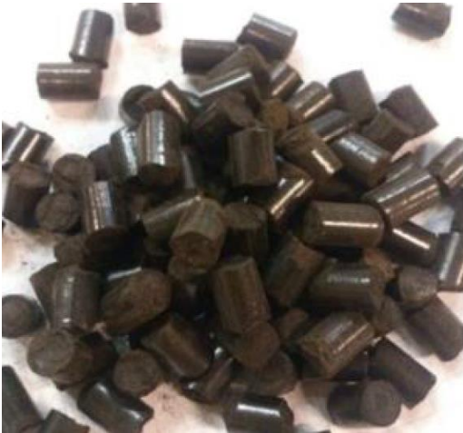
Kuva 3.8 Märkähiillettyä lietettä mekaanisen kuivauksen ja pelletöinnin jälkeen (C Green 2019)
