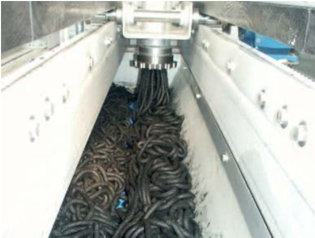
Kuva 3.5. Lietteen syöttö nauhakuivaimelle pursottimella (Huber)
