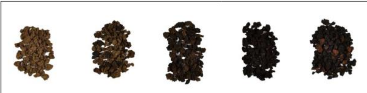
Kuva 3.9 Eri lämpötiloissa torrefioituja ja pyrolysoituja lietteitä. Käsitelyn lämpötila vasemmalta lukien 200, 235, 275, 300 ja 450 °C. Viipymäaika käsittelyssä 15 minuuttia. (Ylivainio et al. 2019)
