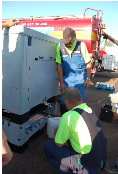
Kuva 6. Kokoontaittava 1 m 3 Combo Aqua -säiliö, jossa kertakäyttöinen sisäpussi vedelle ja puolustusvoimien lämpöeristetty 0,75 m 3 vesisäiliö.
