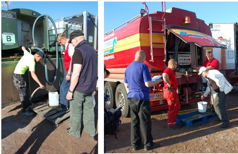
Kuva 4. Puolustusvoimien 2 m 3 vesisäiliö ja Vesihuolto Eerolan 14 m 3 säiliöauto, jossa oma pumppu ja lämpöeristys.
