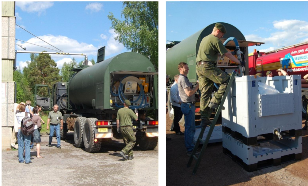
Kuva 7. Vasemmalla säiliöauton täyttö vedenottamolla, oikealla Combo Aqua E säiliön täyttö säiliöautosta.
