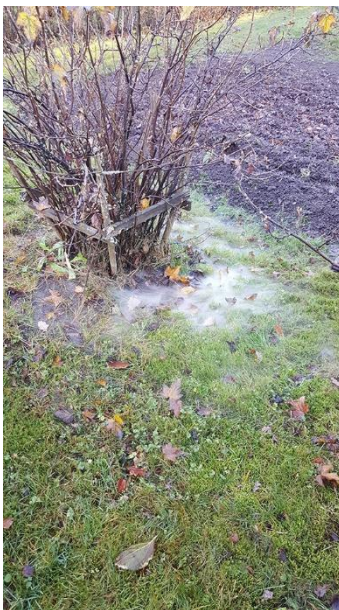
Tonttviemäriin puhallettu savu purkautuu maakerrosten läpi osoittaen tarkemmin tutkittavan kohdan.
