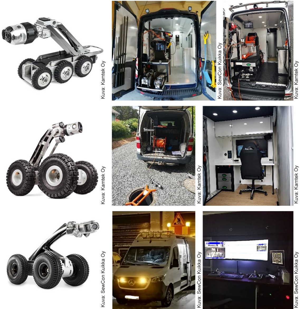
Kuva 13. Esimerkkejä läpiajettavista kameroista ja kuvausautoista.
