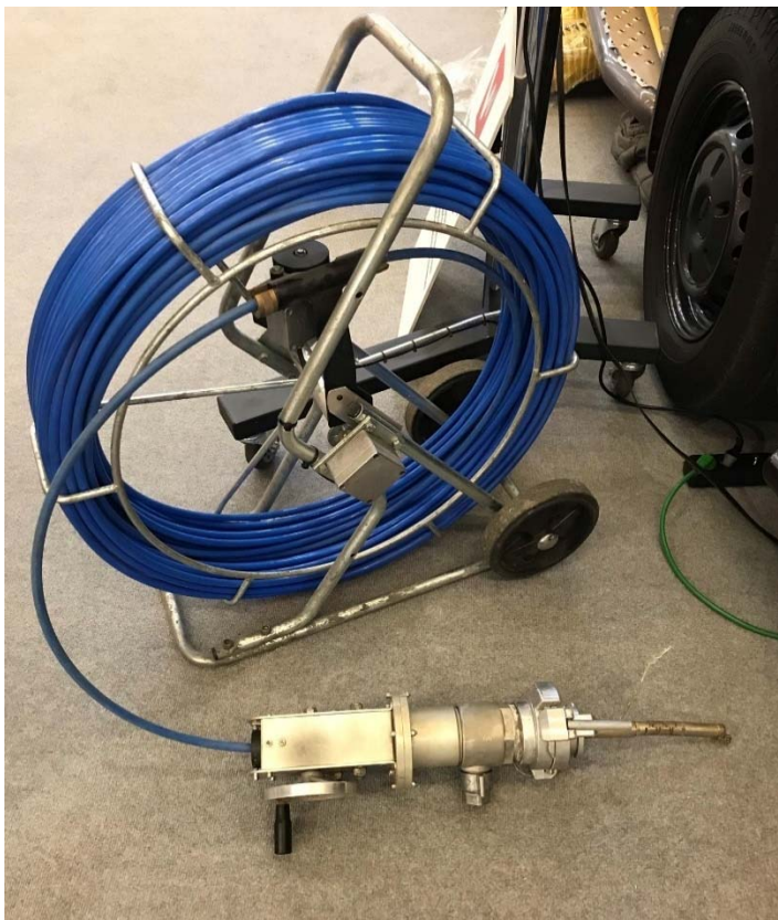
Kuva 25. Pienempi vesijohtokamera. (Kuva: Oy DigiSewer Productions Ltd)
